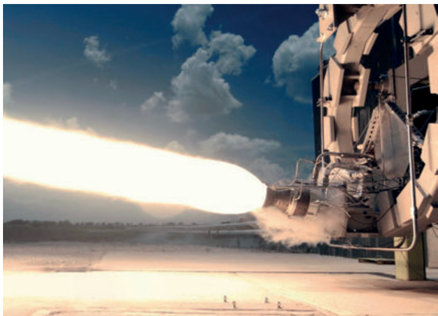
Огневое испытание двигателя Lightning второй ступени ракеты Alpha
